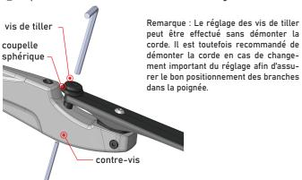
Pour faciliter l'ajustement, des repères sont gravés sur les vis. Les figures présentées ci-après illustrent les 3 positions correspondantes. Le repérage se fait en s'alignant avec le bord le plus "haut" de la poignée.
