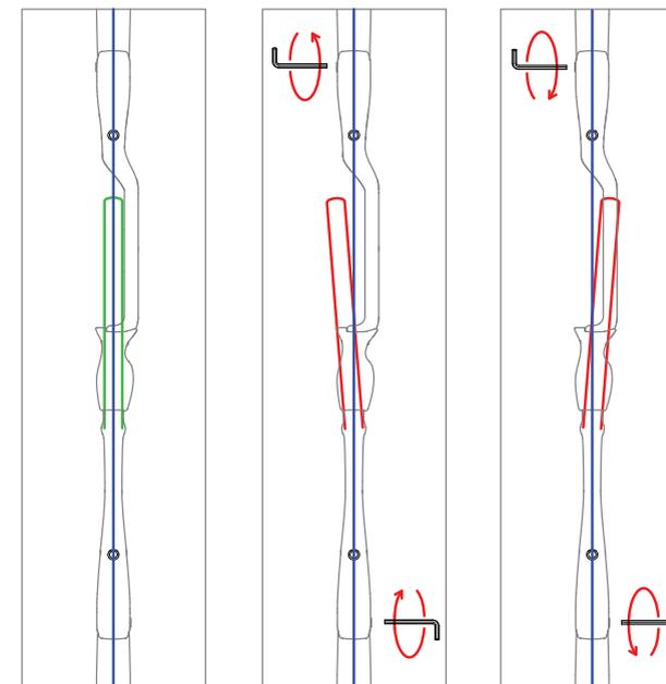
l'extrémité de la stabilisation est alignée avec la corde
