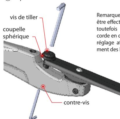
Remarque : Le réglage des vis de tiller peut être effectué sans démonter la corde. Il est toutefois recommandé de démonter la corde en cas de changement important du réglage afin d'assurer le bon positionnement des branches dans la poignée.
